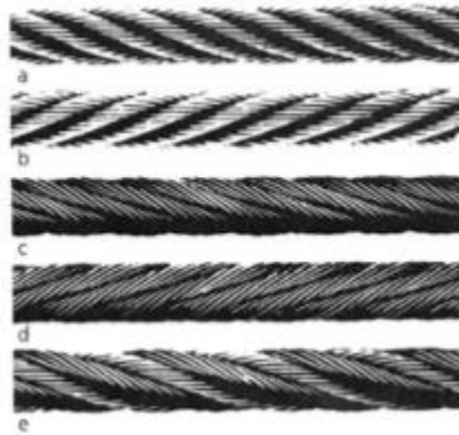
Şekil-2. Halat örüm şekilleri a) Sağ Çapraz, b) Sol Çapraz, c) Sağ Düz, d) Sol Düz, e) Sağ Değişken
