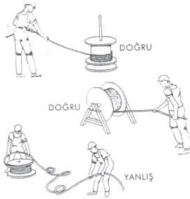
Şekil-8. Doğru ve yanlış halat açılma örnekleri
